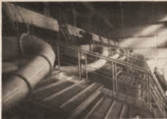
Са отвореног складишта руда се транспортним тракама допрема до система за просејавање у коме се налази два примарна и шест секундарних сита
