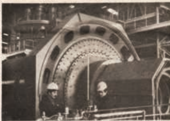
У машини са куглама капацитета 150 тона на час руда се меље до најситнијих честица — од 25 милиметара до 74 микроа и тако припремљена одлази у процес флотациона
